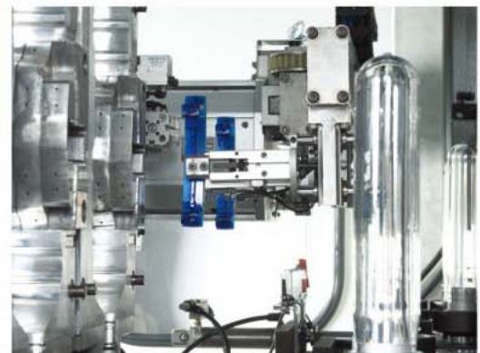
把手前植入系統 Handle Pre-insert Robot
